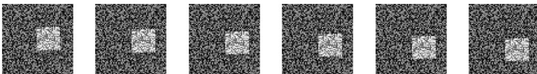
Abbildung 4.1: Testsequenz 1 mit gleichförmiger Abwärtsbewegung eines texturierten Quadrats mit  $T = 5, m_1 = m_2 = 64$ , Reihenfolge von links nach rechts, im ersten Bild ist eine Störung in Form einer Verschiebung nach links eingefügt
