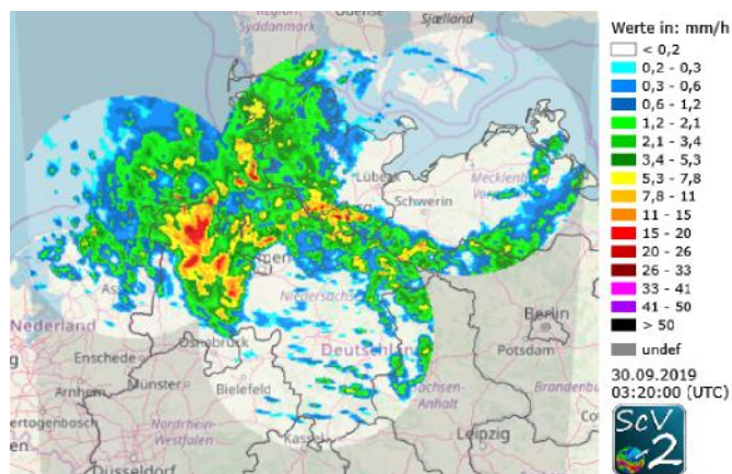
Abbildung 2: Radarreflektivität Z_H bei einem Regenereignis über dem norddeutschen Raum. Zusammenstellung aus mehreren Radarmessungen. Grafik der hydro & meteo GmbH.
