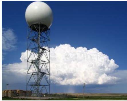
Abbildung 3: WSR-88D Doppler-Wetterradar in South Dakota. Die Radarantenne wird von einer kugelförmigen Schutzhülle, dem Radom, geschützt. Von Eric Kurth, NOAA Photo Library, CC BY 2.0 [Kur04].
