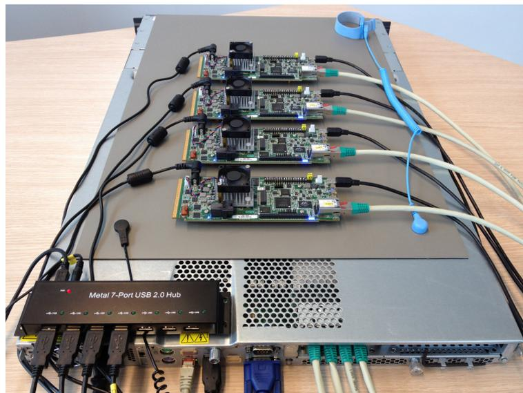
Abbildung 4.4: Testaufbau mit vier DSP-Evaluierungsmodulen
