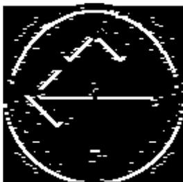
(e) mit Sobelfilter gefiltertes Ausgangsbild
