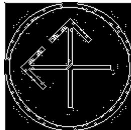
(g) mit Laplacefilter gefiltertes Ausgangsbild
