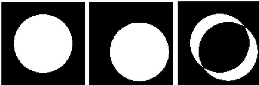
Abbildung 5.3: Synthetische Bilder. Links das Referenz-, in der Mitte das Templatebild, rechts die Differenz vor der Registrierung.
