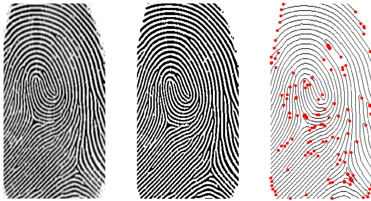
Abbildung 3.5: a) Originalfingerabdruck nach [Cappelli, 2004] (vgl. Abschnitt 3.4.1 b) Binarisierung mittels Schwellwert mit \tau = 240 c) Ergebnis nach Ausdünnung mittels Algorithmus 1 und Minutiendetektion aus Abschnitt 3.3.
